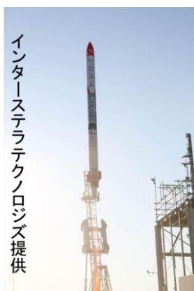
もも3号(Φ50cm × 9.9m, 1.15t)の打上げの瞬間 北海道大樹町の射場にて 最高到達高度: 113.4km
