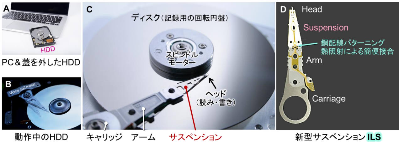
図 2. ハードディスクの大きさと構造(A), 動作の様子(B), 磁気記憶の読み・書き部の構造(C), 及び青柳さんたちが開発した新型サスペンション(ILS: integrated lead suspension)の特徴(D)。B: 高速回転するディスク(表面に磁性体を塗布した円盤=プラッタ)上をキャリッジ・アーム・サスペンションによって支えられたヘッドが Voice coil motor によって走査され、情報の読み書きがなされる様子を示す。C: ヘッドとディスクの間には薄い気流層が形成され、ナノメートル単位の隙間でヘッドはディスクから離れて機能するように設計されている。ディスクは Spindle motor によって駆動される。D: printed patterned suspension (注3) とも言う。出典: A~C, Photolibrary。
