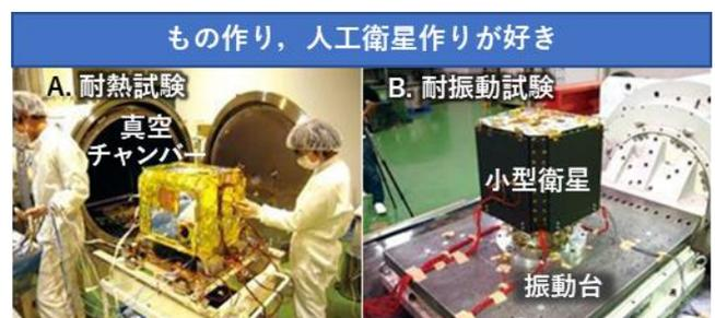
図 2. 大学の研究室で製作した数億円の小型衛星。牟田さんは、熱・機械設計チームに属し、(A)真空チャンバーを用いて熱耐性を検査したり、(B)振動に対する耐性試験をこなしたりしながら、衛星の機械的要素を完成させていった。太陽光パネルの伸展機構もその一つ。
