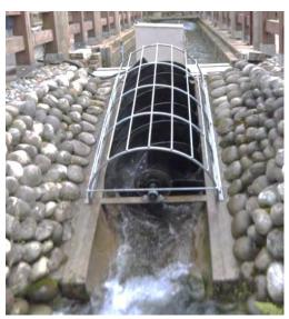
ダイロ(自治研とやま No. 81, 2012 年 7 月号, p16-17): 脱穀などに使っていた らせん式水車。身近にある用水のエネルギーを農作業用の動力に変えるために開発された。この水車は、水量がそれほど多くなくても、また勾配がそれほどきつくない水路でも効率的に動力を生み出すように工夫されている。形がカタツムリに似ていることから「ダイロ」(カタツムリの方言)と呼ぶようになった。富山県下新川郡入善町にある黒部川扇状地研究所が復元し、実際に野外で動体展示している。
