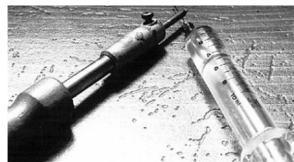
図 2. バブルジェット発明のきっかけとなった「ハンダごてと注射針」。 * 若いエンジニア(佐藤 靖)が半田ごてを使って回路を作っている時に、インクの入った注射器に半田ごてが偶然触れ、インクがピュッと飛び出した。見過ごされそうな小さなアクシデントで、本人も新しい発明につながると思わなかったに違いない。上司の遠藤さんはこの現象に興味を持ち、再現実験を試みた。「オッ、これは ひょっとしたら
