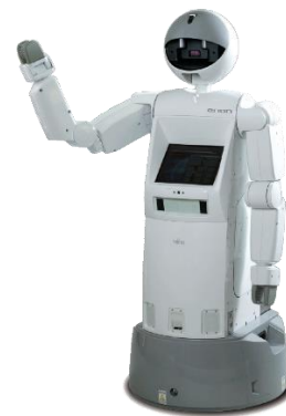
図2. 多様な公共の場で活用できるサービスロボットを目指して開発されたenon。来訪者の出迎え、売り場案内、博物館の展示説明、空港での搭乗口案内、 データセンターの自動巡回 （異常の有無を調べするための巡回業務負担の軽減）、10 kg 以下の荷物の自動搬送などができる。
