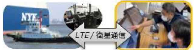
②遠隔操船機能：400km離れた陸上施設から遠隔操船
