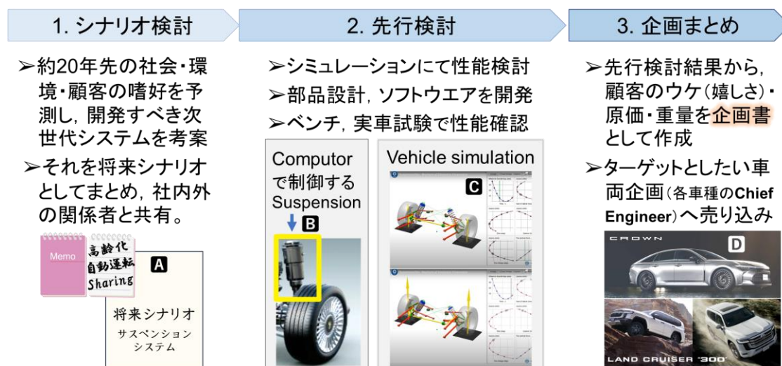
図 7. サスペンション制御システムの開発過程。サスペンションは黄色枠の部品で(B)，中には、アクチュエーター(エネルギーを動きに変える装置)やモーターなど細かい部品が数多く入っており、それらの動作をコンピューターで制御し、乗り心地や操縦安定性等を良くする役割を担っている。企画書に書き込むポイントで顧客を意識したものには、低価格・高性能、サスペンション制御ならば乗り心地・ごつごつしない、操縦安定性、ハンドルを切った時に気持ちよく曲がるなどがある。
